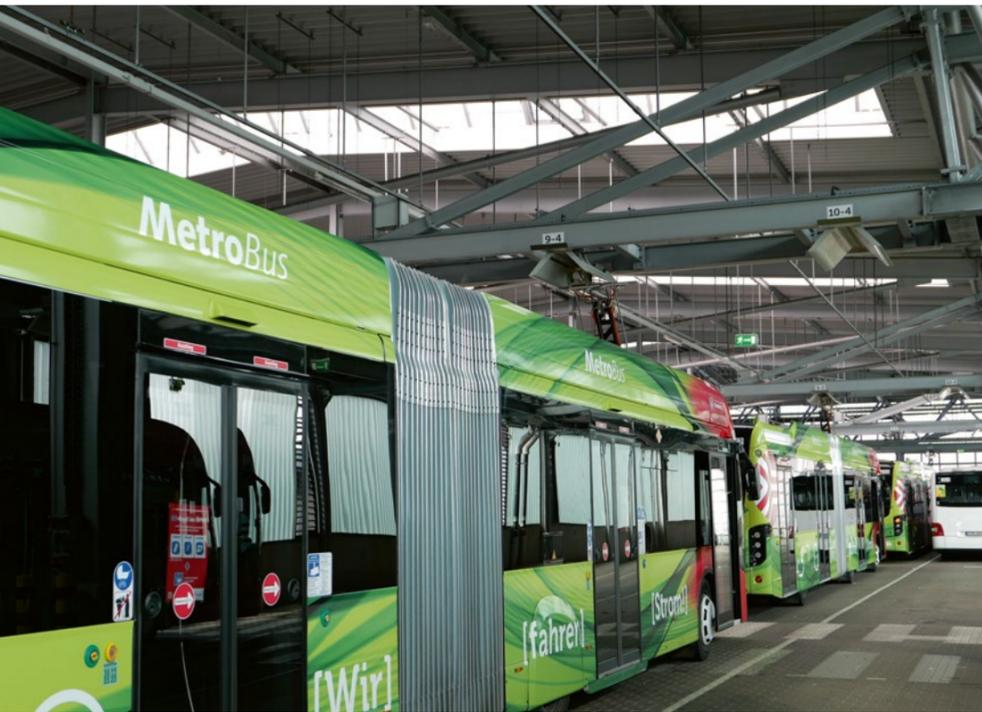
Die Busse werden in der Nacht per Pantograf geladen, Kabelstecken entfällt dabei
