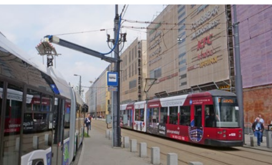
Ideal ist es, wenn der Strom von vorhandenen Tram-Trassen genutzt werden kann
