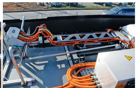
Alternativ befindet sich der Pantograph auf dem Fahrzeugdach, die Funktionalität ist die gleiche
