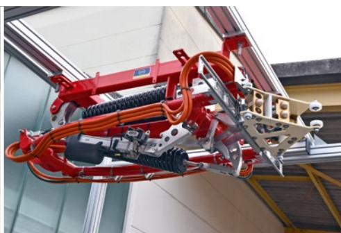
Per Pantograph, der sich in diesem Fall an einem Mast befindet, werden hohe Ladeströme übertragen
